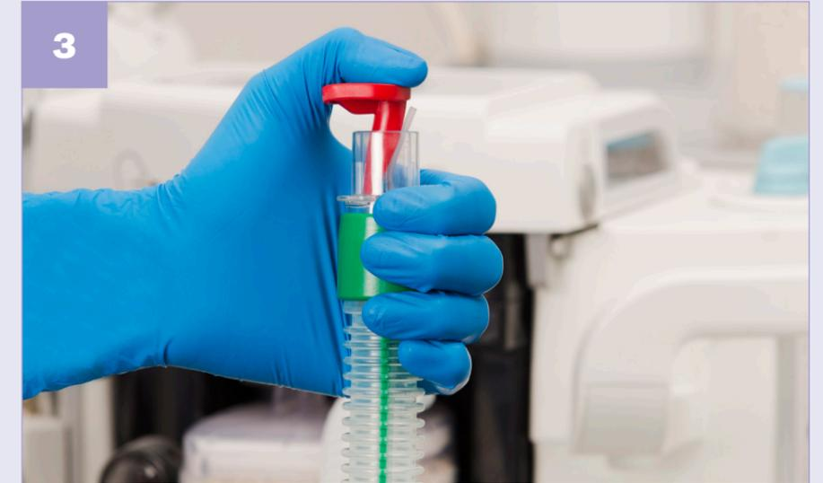
3 A l'aide du testeur de fuite fourni, obturez la section expiratoire du circuit au niveau de la connexion Patient.
